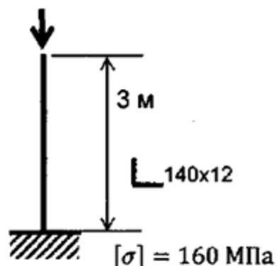
Определить критическую нагрузку для стойки
